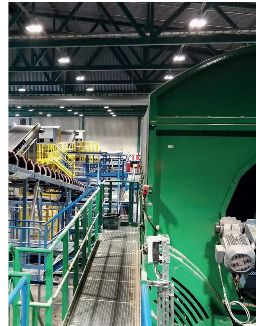
Lähes puoli kilometriä kuljettimia siirtävät jättemateriaalin mm. etualalla olevalla rumpuseulalla.
