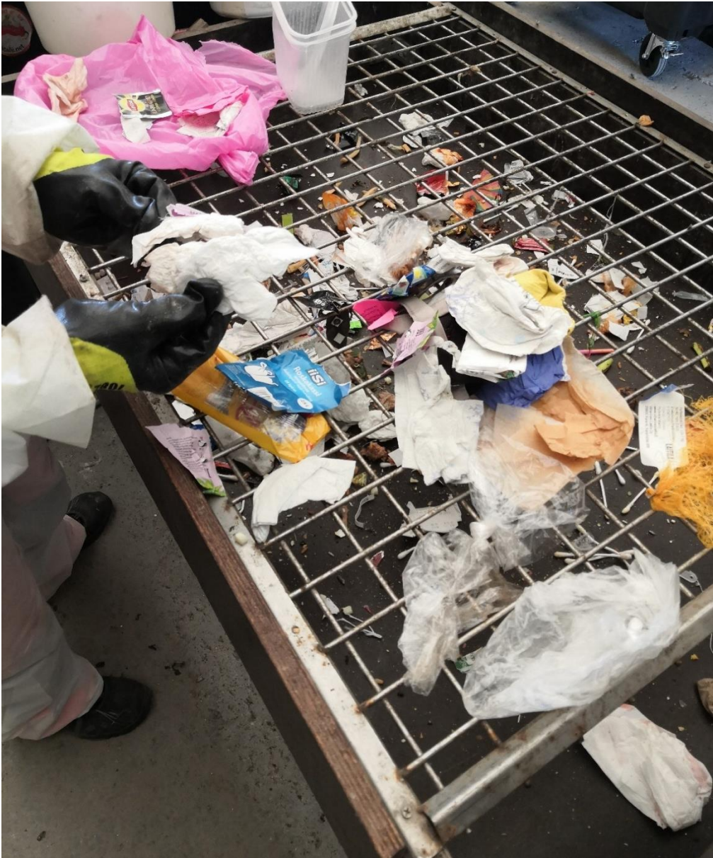
Kuva 6. Roskapussin sisältö levitettiin seulan päälle, josta jätteet lajiteltiin omiin kategorioihinsa. Hienoaines kerääntyy seulan alle.
