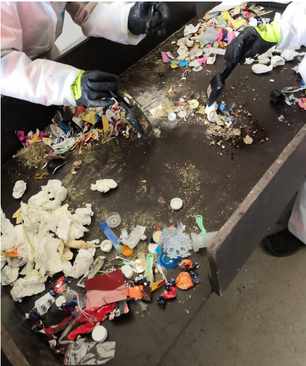
Kuva 9. Hienoaines jaettiin silmämääräisesti eri jätelaajluokkiin, jotka punnittiin erikseen.
